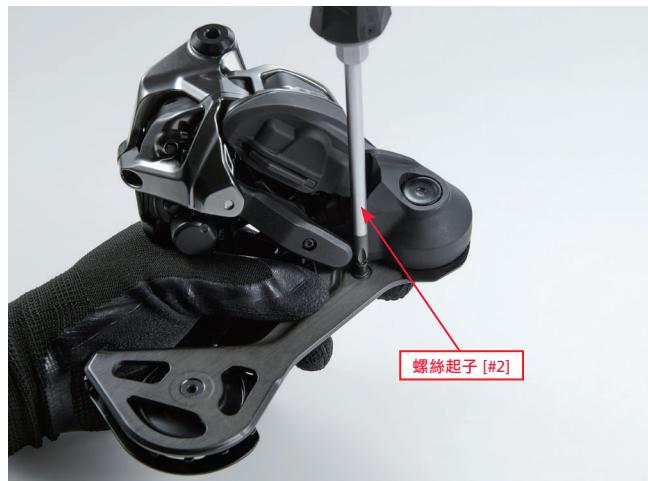
4. 更換導板彈簧基座，並在背板軸螺絲、導板彈簧基座中心以及平板張力彈簧上塗抹高級潤滑油。
